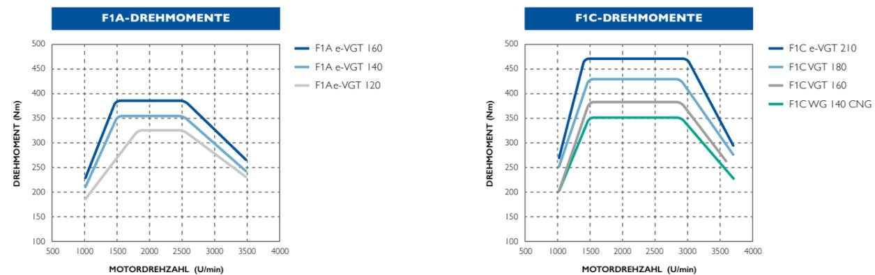
e-VGT: elektronisch gesteuerte variable Turbinengeometrie; VGT: variable Turbinengeometrie; WG: WasteGate; CNG: Compressed Natural Gas
