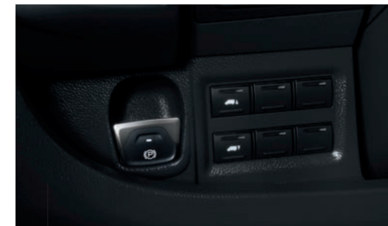
Machen Sie sich frei von Handbremshebel, Halterung und Kabeln: mit der neuen elektrischen Parkbremse für mehr Komfort und Bewegungsfreiheit.
